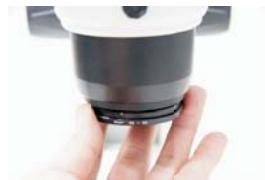
固定ねじを異形リングに合わせて止めて止めることで抜け落ち防止になります。
