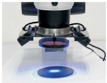
対物レンズ先端に補助レンズが取り付けられるタイプには、異形リングを付けてから蛍光ユニットを取り付けます。
